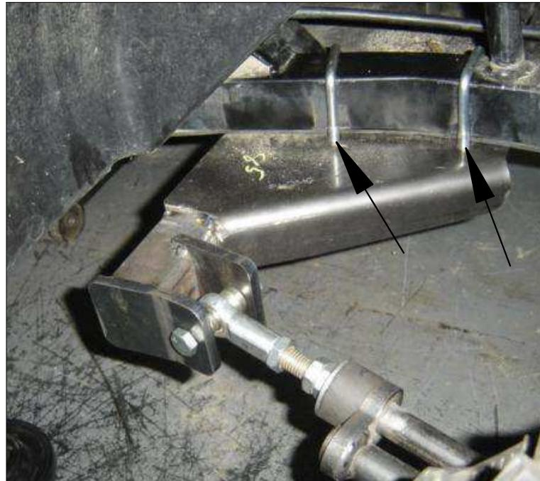
Placer la plaque pour que les boulons en U épousent bien la forme de la structure du véhicule.
