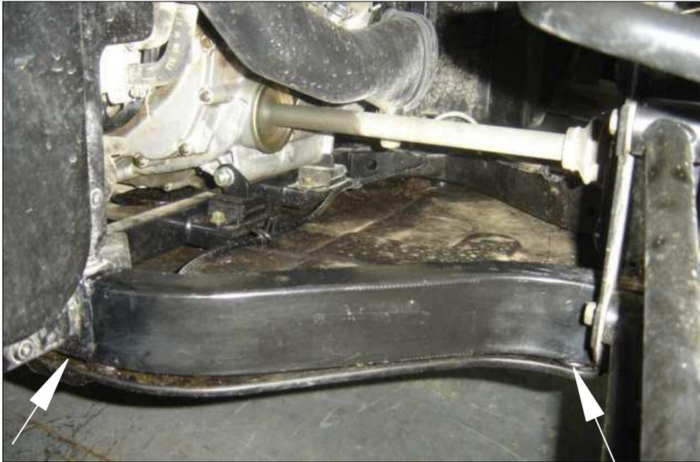
Tailler le garde de plastique de façon à ce qu'il soit égale à la structure du véhicule partout entre les flèches.
