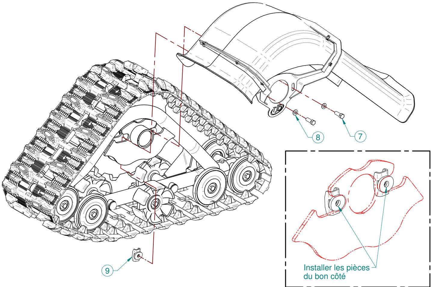
**ÉTAPE 3** - Ajustez les ailes de façon à ce que l'avant et l'arrière des ailes soient à distance égale de la chenille .
